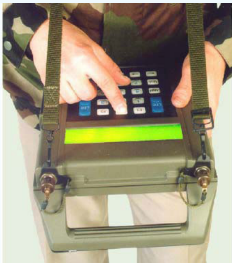
přenosná čtečka/rekordér XOM/R a XOM/T pro NBC dozimetrii
