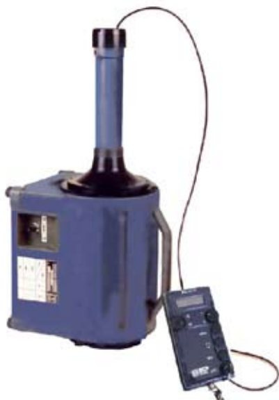
Použití vzorkovače s \alpha sondou 121 cm 2 a Multiradem
